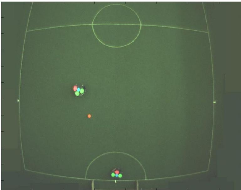
*Abbildung 6.1:* Tonnenförmige radial verzerrtes Bild des Spielfelds, aufgenommen mit einem 4.2mm Objektiv bei einer Höhe von 2.55 Metern. Die geraden Linien sind stark gekrümmt und Kreise erscheinen ellipsenförmig im Bild.
