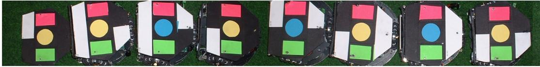
**Abbildung 5.5:** Mehrere Roboter mit 3-Marker-Modell und 4-Bit Schwarz-Weiß Kodierung. Alle Roboter sind nach links ausgerichtet. Das niederwertigste Bit der Kodierung ist vom Roboter aus gesehen vorne links, das höchstwertigste hinten rechts. Von links nach rechts sind folgende ID's zu sehen: 2, 7, 11, 1, 10, 13, 12, 5.
