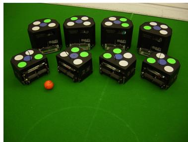
**Abbildung 5.7:** Das Modell des Teams der Carnegie Mellon University. Es verwendet vier zusätzliche asymmetrisch angeordnete Marker mit zwei möglichen Farben und ermöglicht 16 verschiedene ID's zu unterscheiden.
