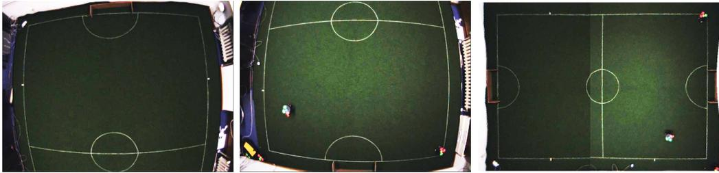
**Abbildung 6.8:** Die beiden linken Bilder zeigen die lokalen Sichten zweier Kameras über dem Spielfeld. Die Sichten überlappen in der Mitte, so dass ein Roboter immer in mindestens einer Sicht vollständig zu sehen ist. Das rechte Bild zeigt, wie in der 3D Ansicht der Vision-Software die Texturen beider Kameras in Echtzeit mithilfe der Transformationsfunktion in das Spielfeldkoordinatensystem gelegt werden. Dies dient lediglich der Visualisierung.
