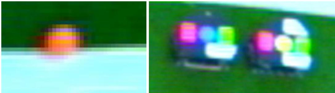
**Abbildung 3.3:** Beide Bilder zeigen die Entstehung falscher Farben. Rechts sieht man wie der blaue Marker die anderen überstrahlt, so dass an Übergängen Farbmischungen erzeugt werden. Der gelbe Teammarker hat aufgrund des *Blooming* – Effekts an Sättigung eingebüßt.
